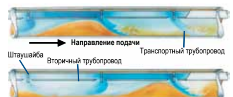
Принцип экстремально медленной подачи в трубе TURBUFLOW®
